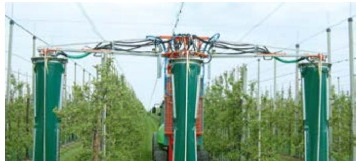
Das WIESEL System Flat-Net ermöglicht Reihenabstände bis 11 m und Durchfahrtshöhen bis maximal 5 m.
